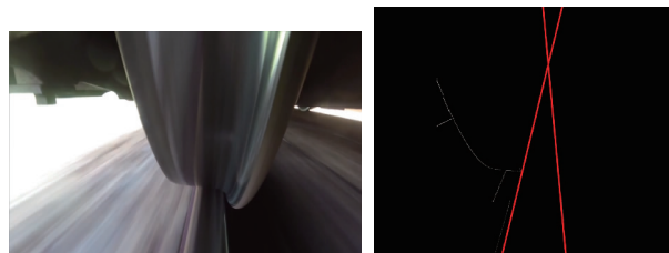
图8 高速运行状态下的轮轨图像 图9 钢轨匹配结果图像
