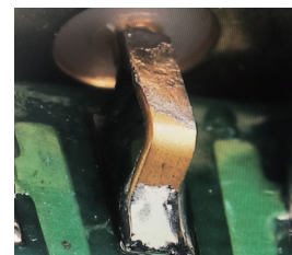
图8 连接器焊接部位裂纹图 图9 连接器金箔软搭接图
