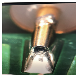
图8 连接器焊接部位裂纹图 图9 连接器金箔软搭接图
