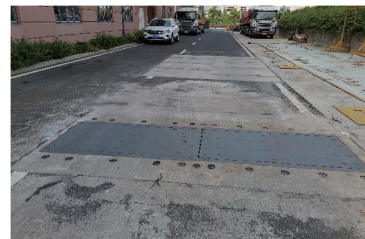
图12 称重校准实验所用平板式动态汽车衡
