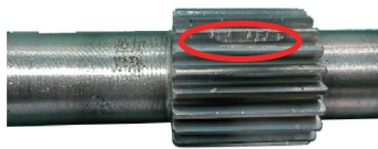
图 10 点蚀故障齿轮试验件
