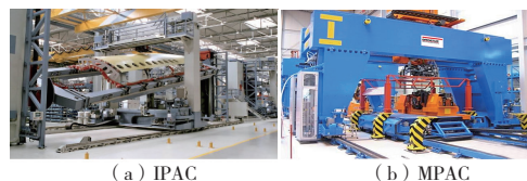
图 4 德国 BROETJE 公司的部分自动钻铆机
