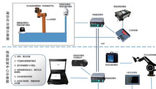
图9 配网带电作业机器人系统
