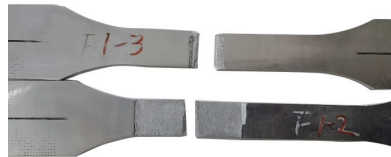
图 5 母材疲劳试样断裂示例
