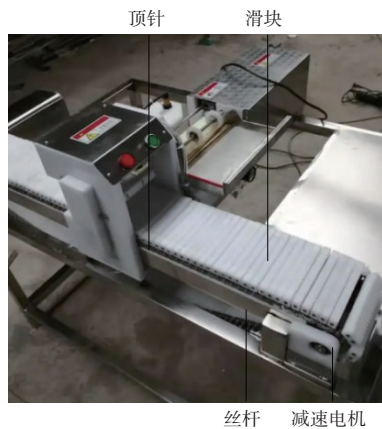
图 1 小型自动穿串机给进器结构示意图
