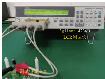
图 4 电解电容测试实物图
