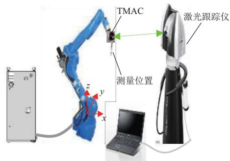
图 9 机器人测量单元
