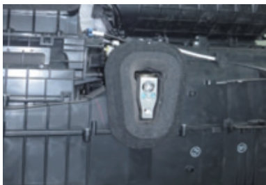
图9 空调膨胀阀优化示意图
