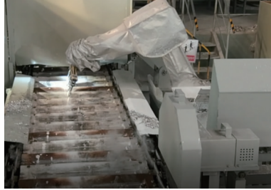
图4 机器人捞渣图
