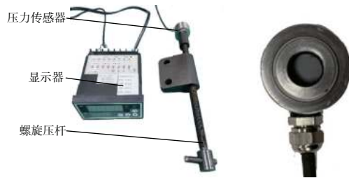
图5 矫形力施加结构与环形压力传感器
