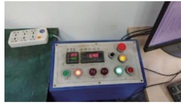
图 6 加载装置控制台
