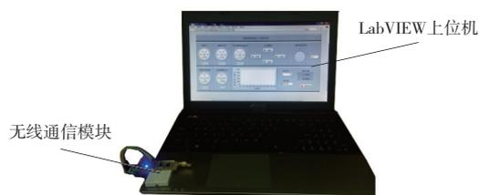
图 7 消防机器人上位机控制系统
