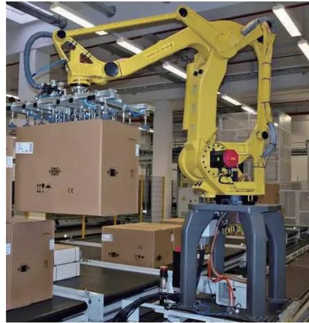
图 4 生产线搬运机械手抓取定位控制现场图
