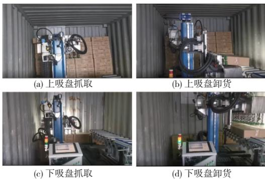
图 6 抓取系统卸货过程
