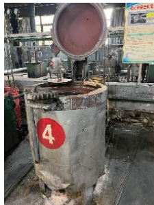
图2 传统硫化罐实物图
