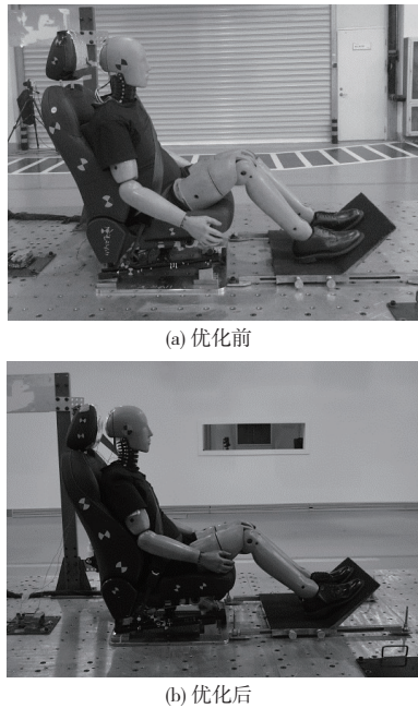
图 7 鞭打试验现场
