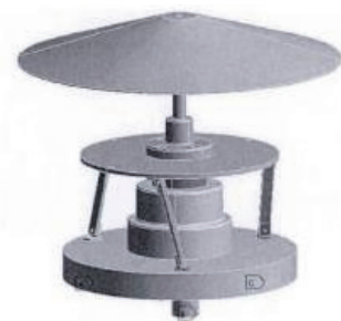
图 5 主振机给料装置定义约束模型
