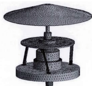
图 4 主振机给料装置有限元网格划分模型
