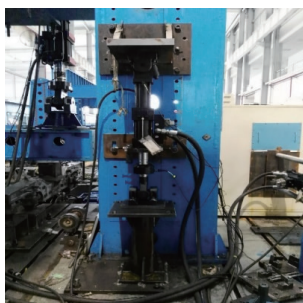
图1 橡胶垫静刚度试验台
