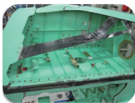
图7 固化后的液体垫片
