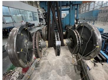
(c) 工况3-车轴中间制动盘两侧吊挂
