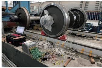
图2 模态试验测试系统组成
