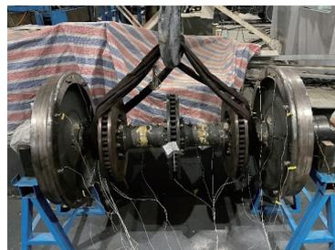
(d) 工况4-橡胶堆弹性支撑轮对
