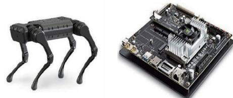
(a) 四足井下探测机器人 (b) TX2控制器
