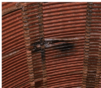
图3 变压器绕组线圈形变示意图
