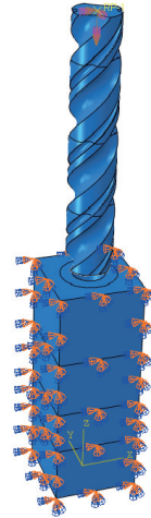
图 4 叠层结构三维模型边界条件设置
