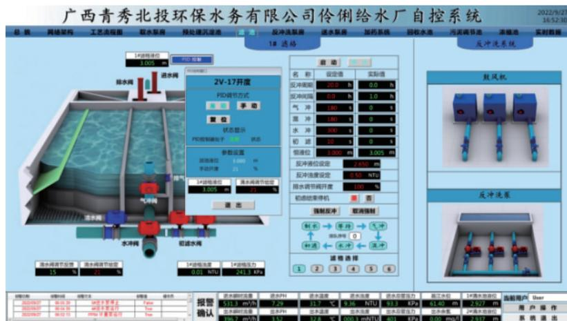
图7 滤池设备自动过滤及反冲洗系统
