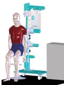
图 6 外骨骼康复机器人左右手臂互换示意图
