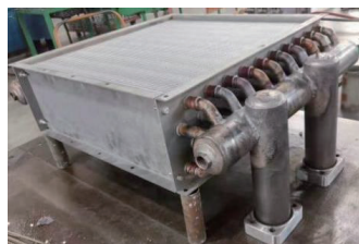
图3 铜芯管与碳钢法兰固定
