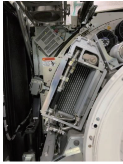
图2 球管安装位置
