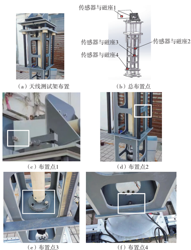
图6 天线测试架上传感器的布置点
