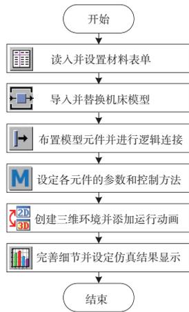
图3 仿真建模步骤流程图
