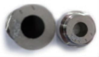
图 3 拉伸试件断口形貌
