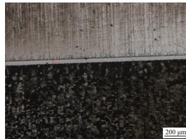
图 5 钎焊接头焊缝组织
